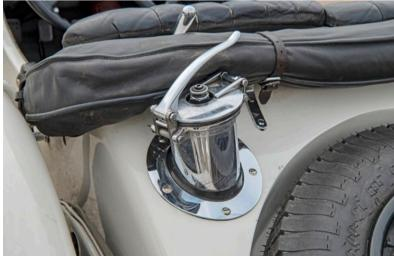
Der mächtige Siebenliter-Sechszylinder leistet mit Elefanten-Kompressor 300 PS. Beim Nachtanken des SSKL hilft der Schnellverschluss
